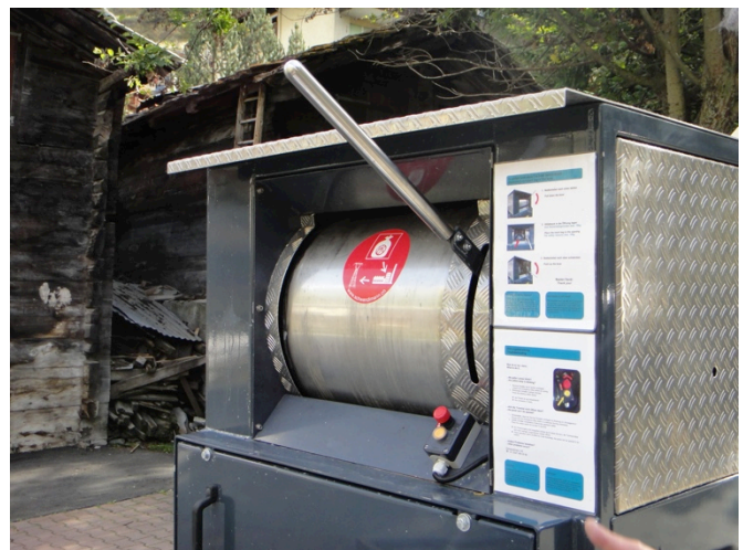
Abbildung 3: Presscontainer für Kehrriichtsäcke (Quelle: Rytec AG, © www.system-alpenluft.ch)
